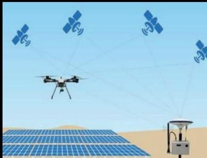
Configuration RTK double Le module de positionnement haute précision au niveau centimétrique RTK intégré, avec une capacité de positionnement précise, fournit des données de positionnement au niveau centimétrique en temps réel, améliorant considérablement la précision absolue des données.
