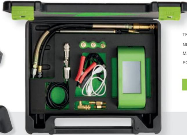
TESTEUR DE TEST DE COMPRESSION NUMÉRIQUE, COMPLET À LA DEMANDE ! Mamelons et fausses bougies de préchauffage POUR LES SYSTÈMES DIESEL
